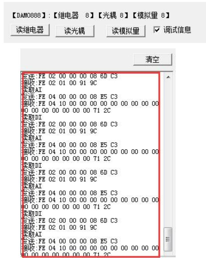
指令生成说明：对于下表中没有的指令，用户可以自己根据 modbus 协议生成，对于继电器线圈的读写，实际就是对 modbus 寄存器中的线圈寄存器的读写，上文中已经说明了继电器寄存器的地址，用户只需生成对寄存器操作的读写指令即可。例如读或者写继电器 1 的状态，实际上是对继电器 1 对应的线圈寄存器 0001 的读写操作。
