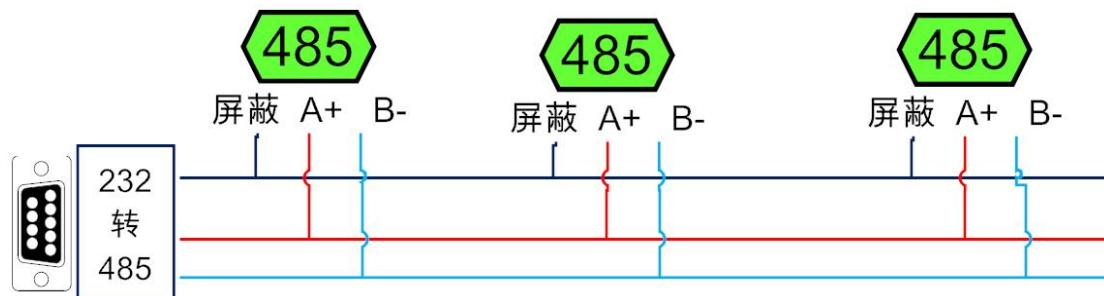
电脑自带的串口一般是 RS232，需要配 232-485 转换器（工业环境建议使用有源带隔离的转换器），转换后 RS485 为 A、B 两线，A 接板上 A 端子，B 接板上 B 端子，485 屏蔽可以接 GND。若设备比较多建议采用双绞屏蔽线，采用链型网络结构。
