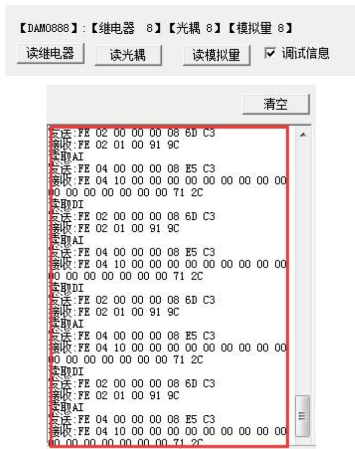
**指令生成说明:** 对于下表中没有的指令, 用户可以自己根据 modbus 协议生成, 对于继电器线圈的读写, 实际就是对 modbus 寄存器中的线圈寄存器的读写, 上文中已经说明了继电器寄存器的地址, 用户只需生成对寄存器操作的读写指令即可。例如读或者写继电器 1 的状态, 实际上是对继电器 1 对应的线圈寄存器 00001 的读写操作。
