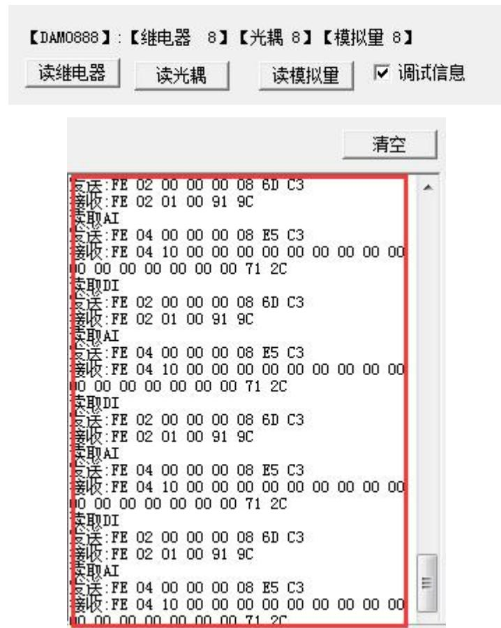
指令生成说明：对于下表中没有的指令，用户可以自己根据 modbus 协议生成，对于继电器线圈的读写，实际就是对 modbus 寄存器中的线圈寄存器的读写，上文中已经说明了继电器寄存器的地址，用户只需生成对寄存器操作的读写指令即可。例如读或者写继电器 1 的状态，实际上是对继电器 1 对应的线圈寄存器 00001 的读写操作。
