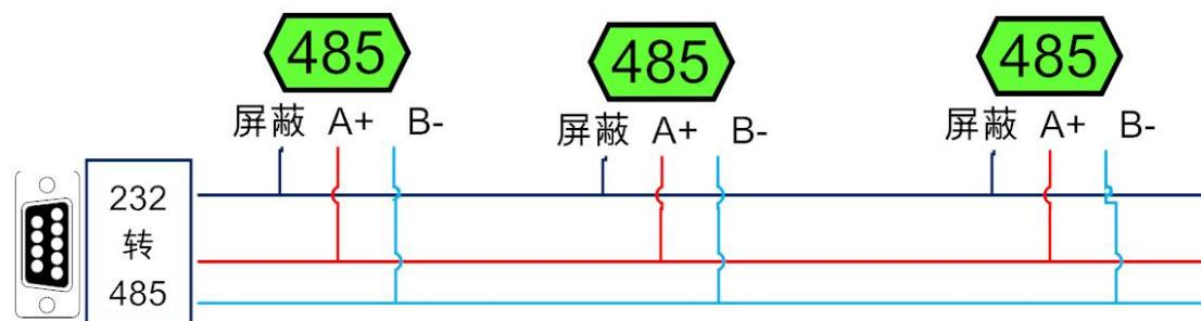
电脑自带的串口一般是 RS232，需要配 232-485 转换器（工业环境建议使用有源带隔离的转换器），转换后 RS485 为 A、B 两线，A 接板上 A 端子，B 接板上 B 端子，485 屏蔽官网：[www.juyingele.com](http://www.juyingele.com) 联系电话：010-82899827/1-803
